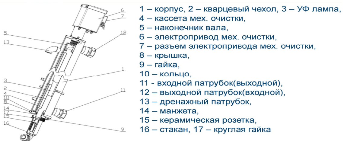
Рисунок 4 – Устройство обеззараживающей камеры Модуля
